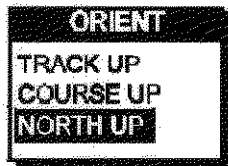
Fig. A: Puede elegir entre "TRACK UP" (con la dirección hacia la que se mueve en la parte superior de la pantalla), "COURSE UP" (destino del tramo actual en la parte superior de la pantalla) y "NORTH UP" (el Norte está en la parte superior de la pantalla).
