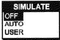
Fig. A: Si selecciona "USER", el equipo le pedirá que introduza los datos para SOG (velocidad) y COG (rumbo).
