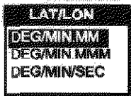
Fig. C: Puede elegir entre DEG/MIN.MM (grados/minutos.centésimas), DEG/MIN.MMM (grados/minutos.milésimas) o DEG/MIN/SEC (grados/minutos/segundos).
